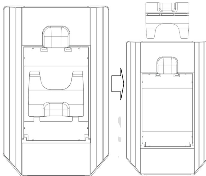
Шаг 2: Подготовка: снимите фиксатор
