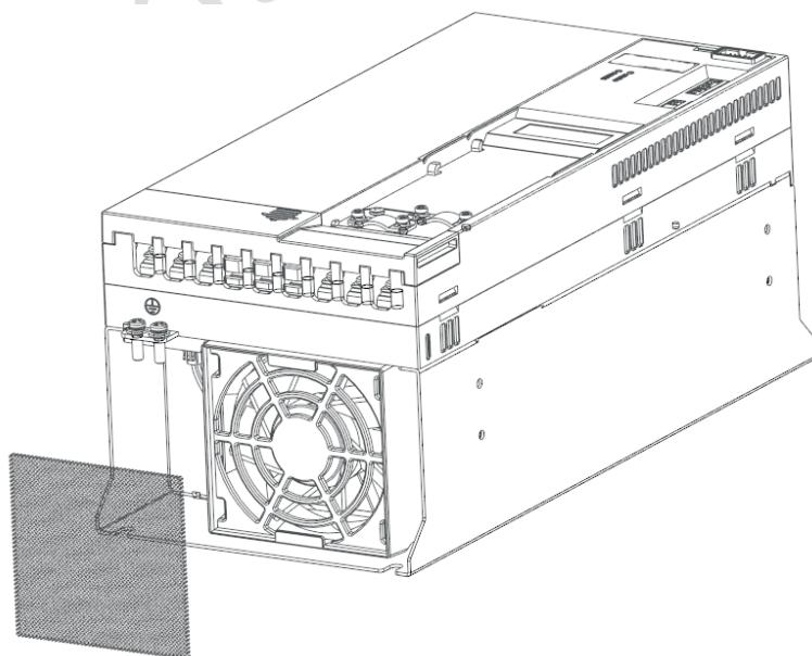
1 □ Слегка сожмите фильтр сверху-снизу и вставьте его в опорную часть вентилятора
