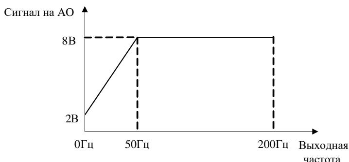
Если Р3-52=80.00% (40 Гц), Р3-53 = 10.00% (5 Гц), соотношение между выходной частотой и выходным сигналом на выходе АО показано ниже:
