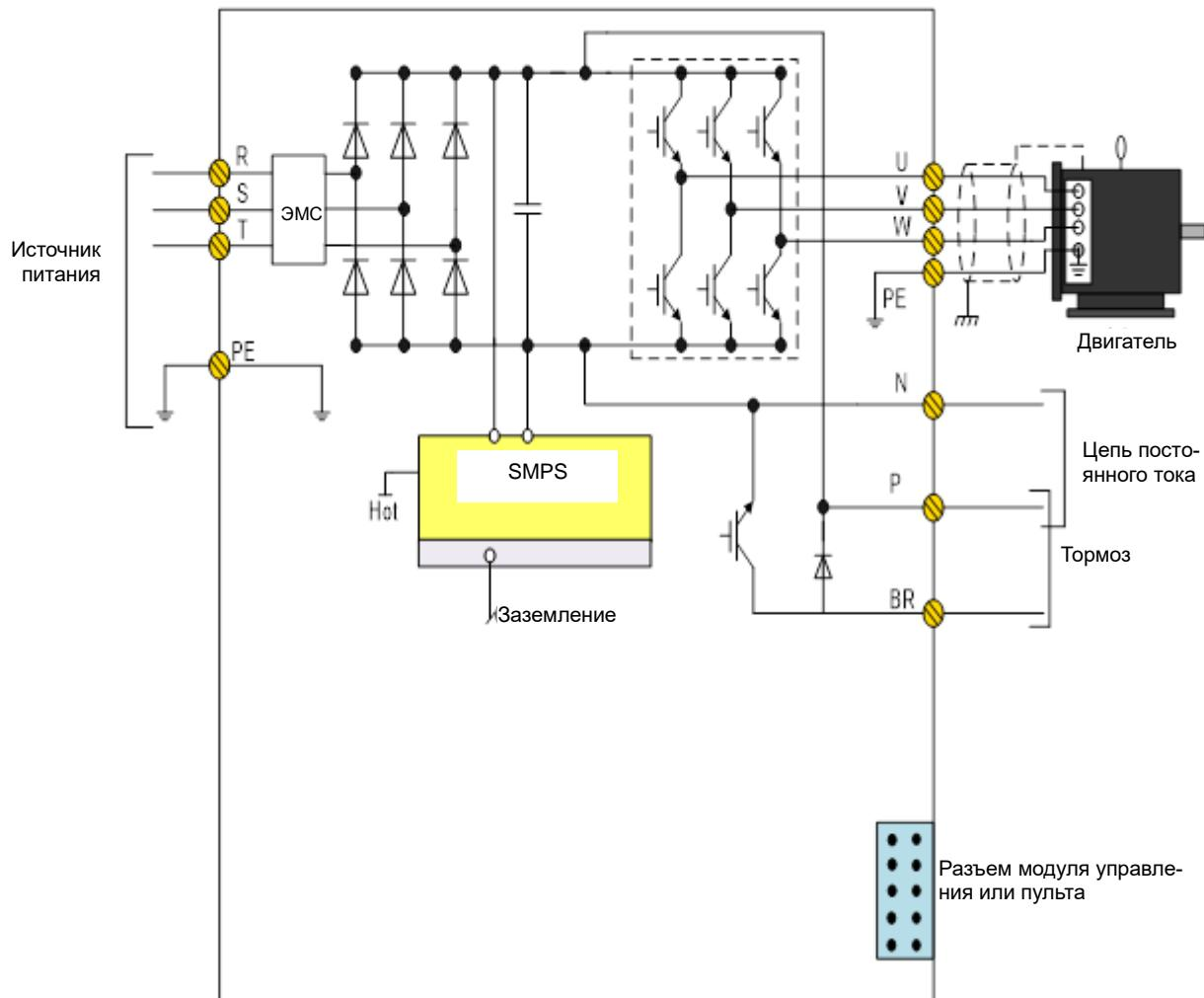
**Силовой модуль PU01 (11-22 кВт)**
